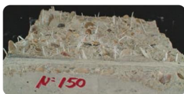
Macroglasvezels uit de matrix getrokken op het breukvlak
